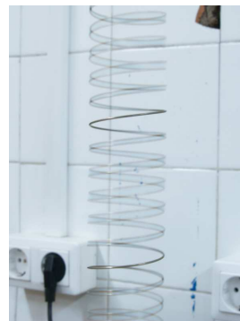
(b) Onda estacionaria en un muelle
